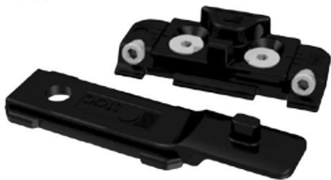
Mecanismo que permite una posición de aireación. Es aplicable tanto en ventanas oscilobatientes como practicables. Consta de un cerradero regulable y una corredera. El diseño especial del cerradero hace que al girar la cremona, la hoja se posiciona de manera que quede abierta entre 1 y 8 mm aproximadamente. Esta apertura se puede variar regulando el cerradero.
